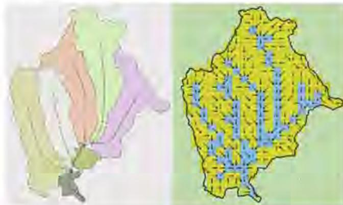
Figura 4.24. División de una cuenca y conceptualización de la red de drenaje en subcuencas (izquierda) y en subunidades artificiales (derecha).
